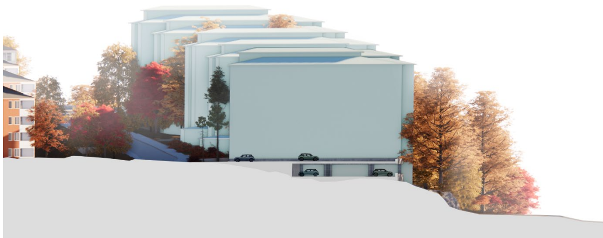
Figur 7. Illustration över gemensam parkering i norr som utförs där marken är gynnsam för två nivåer av markparkering. Den översta bildar ett bjälklag över det nedre.
